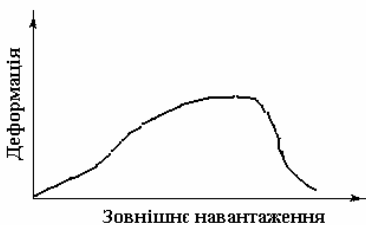
Рис. 4.18 – Діаграма “напруга – деформація” для бетону
