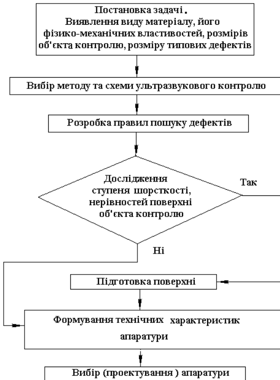
Рис. 4.1 – Алгоритм розв’язання задачі неруйнівного контролю якості матеріалів ультразвуковим методом
